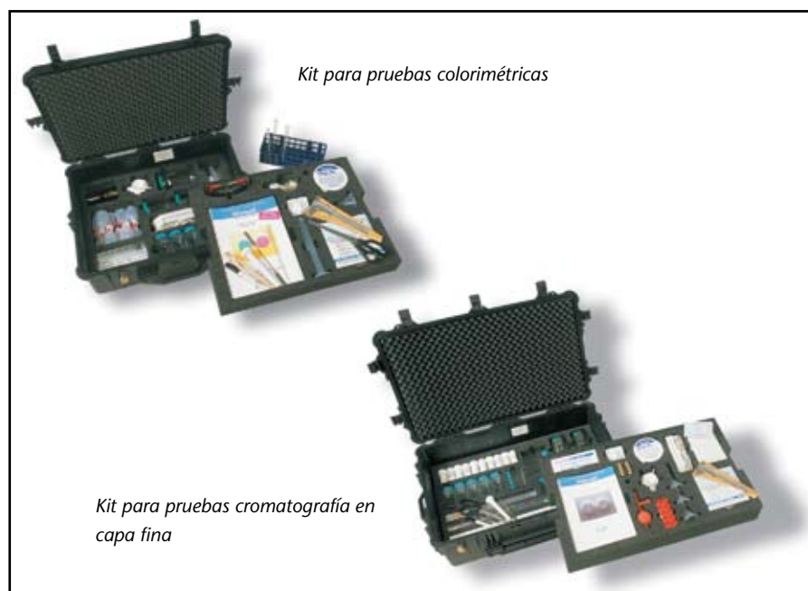
El equipo básico del GPHF-Minilab®, los manuales y un muestrario completo de más de cuarenta estándares secundarios de referencia están contenidos en dos maletas altamente resistentes.
